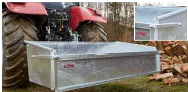
Beonders robuste Ausführung durch Versteifungen an den Stirnseiten der Heckschaufel
