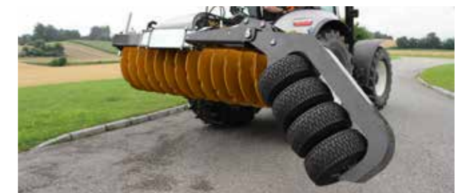
Für eine sichere Verdichtung bei Silos ohne Wände empfiehlt sich die Verwendung eines Kantenverdichters (Zubehör).
