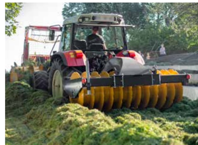
Silieren mit höchster Effizienz: Mit der Kombination aus Siloverteiler und Silowalze kann in einem Arbeitsschritt verteilt und verdichtet werden.
