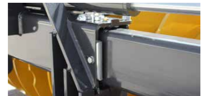
Der gleitlagergeführte Rahmen sorgt für einen leichtgängigen Seitenvershub und eine lange Lebensdauer.
