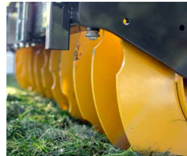
Der Abstand der Scheiben zueinander garantiert eine gleichbleibende Verdichtungsarbeit ohne Futterstau in den Zwischenräumen.
